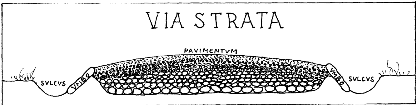
Querschnitt durch eine römische Fernstraße (nach einer Zeichnung des Verfassers)
